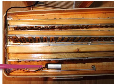
**3.0 Соединяем разомкнутые разъемы, закрепляем соединительные элементы, герметизируем клеем единственное сквозное отверстие внутри инструмента.**
