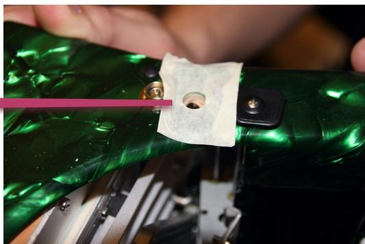
Диаметр сверла 6 мм
